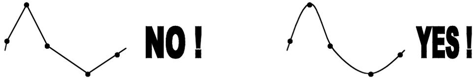
*Figure 8 Connecting the equipotential points*
